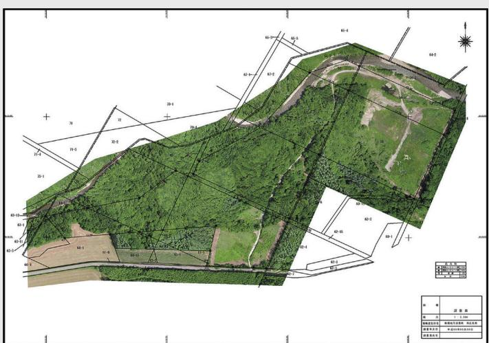
コース撮影を行いオルソ写真を基に図面と合成し現況平面図面を作成
